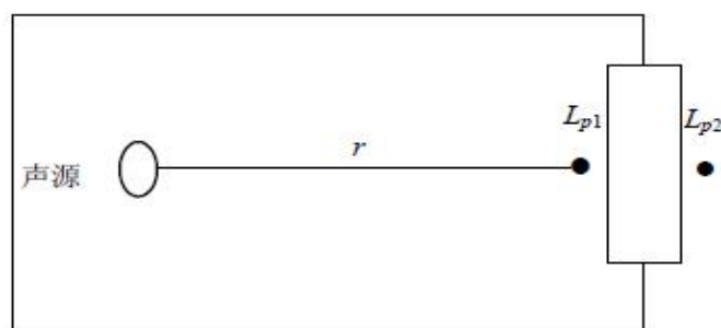
图 A.1 室内声源等效为室外声源图例
